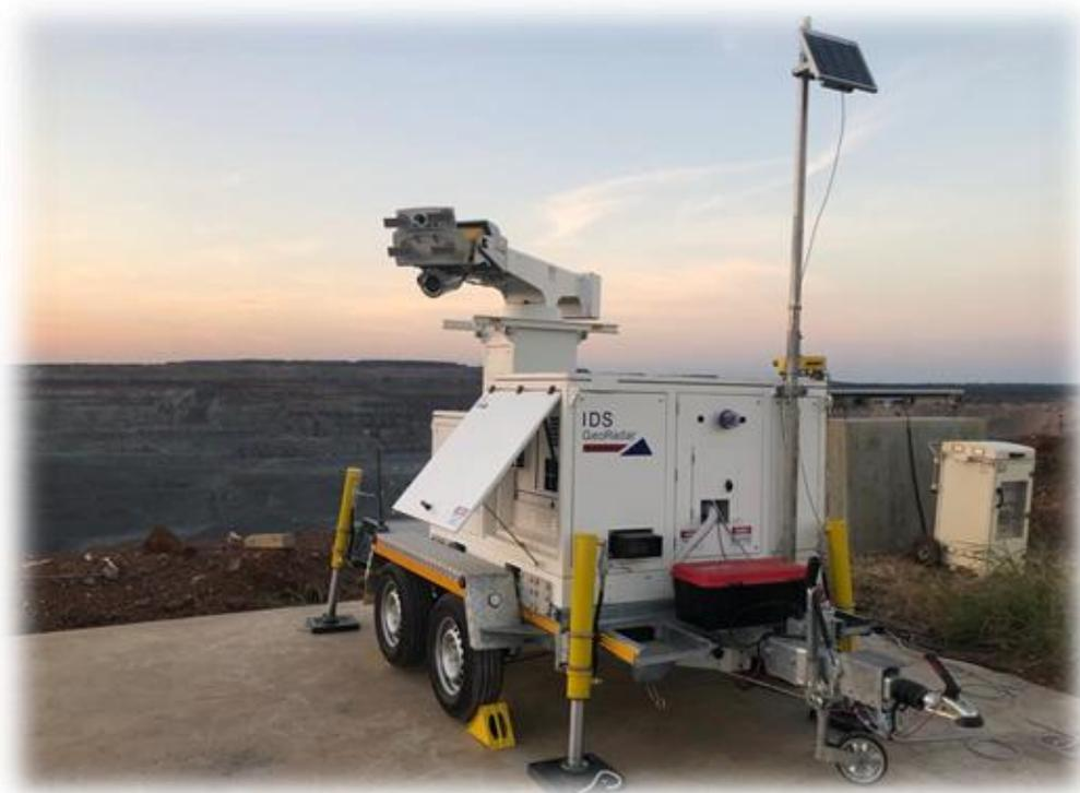
Рисунок 3.4 - Радиолокационная система (ArcSAR от IDS GeoRadar) [62]
